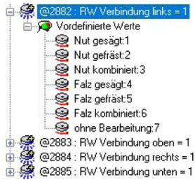
Das Bauteil Bearbeitung\_einzeln aus der Gruppe Position wird über eine Kurve eingefügt. Die Bearbeitung ist für jede Seite einzeln als Werkzeug hinterlegt und kann über den Parameter „RW Verbindung“ gesteuert werden.
