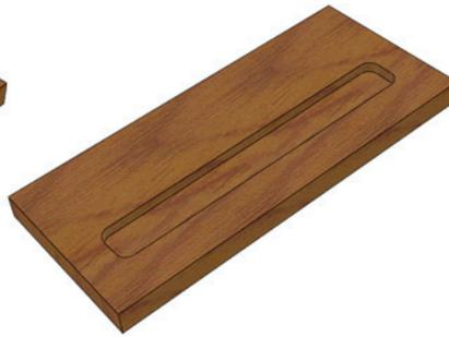
Mit einem 20er-Werkzeug und Nachbearbeitungsradius von 2 mm
